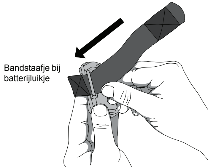
Afbeelding 9: Bevestigen verstelbare polsband
